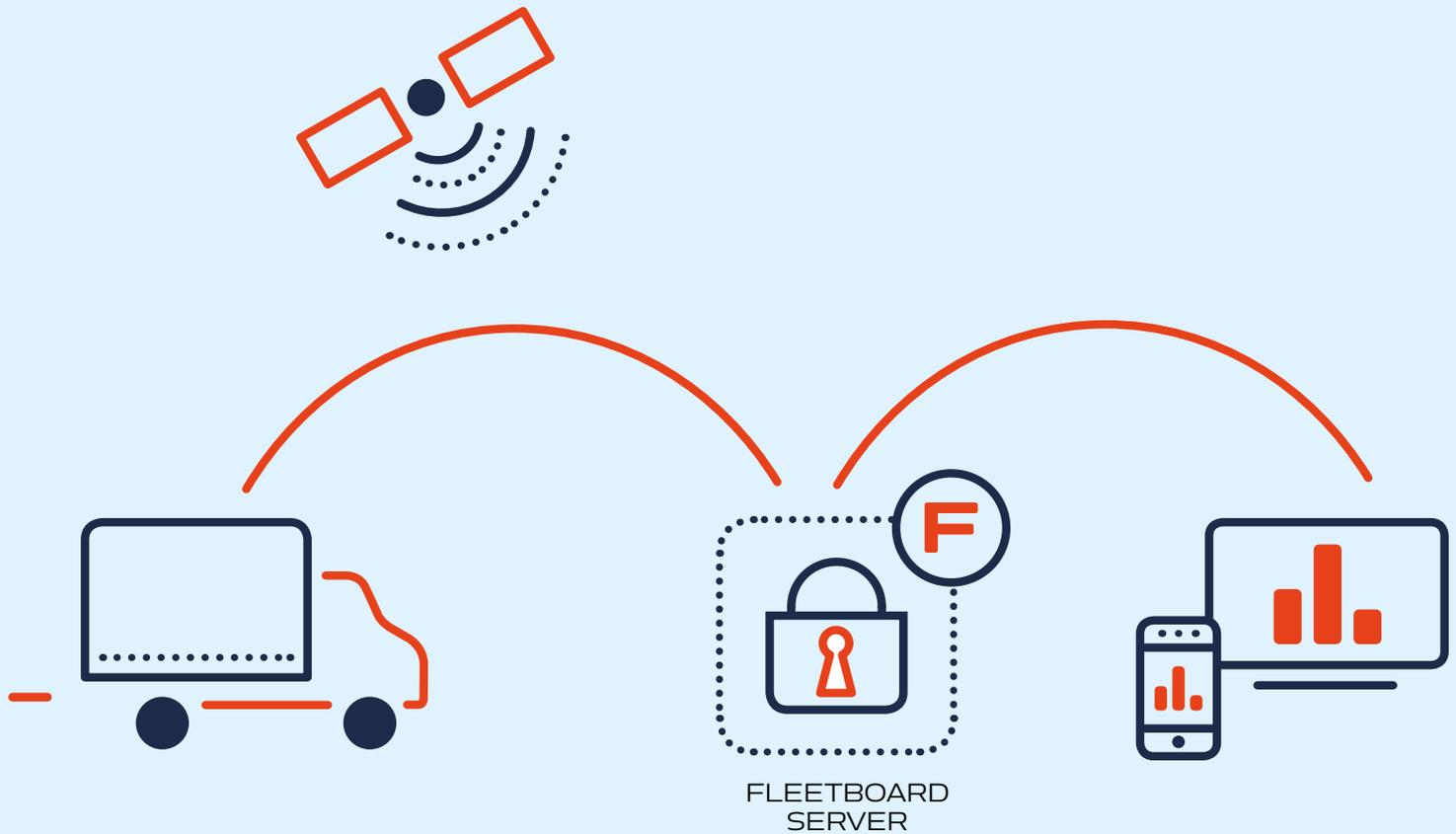
Über die Fahrzeugschnittstelle greift Fleetboard auf die Elektronik des Fahrzeugs zu und übermittelt Fahrzeug- und Fahrerdaten an die Fleetboard Server via GSM/GPRS.
